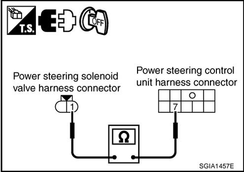
**5. CHECK POWER STEERING SOLENOID VALVE GROUND CIRCUIT**
